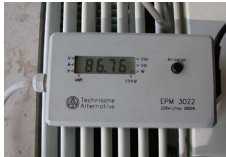
Abbildung 3.6: Strommessung mit Zwischenstecker
