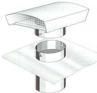
Abbildung 3.53 a-b: Ansaugung über Dachansaughaube aus Edelstahl, kein Filter. Druckverlust < 2Pa bei 200 m³/h Quelle Druckverlustgrafik bzw. Konstruktionszeichnungen: Fa. Westaflex
