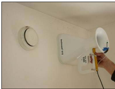
Abbildung 3.7: Messaufnahme mit Hilfe des Messtrichters
