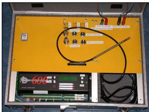
Abbildung 3.2: Messkoffer mit Anschlüssen der Messaufnehmer
