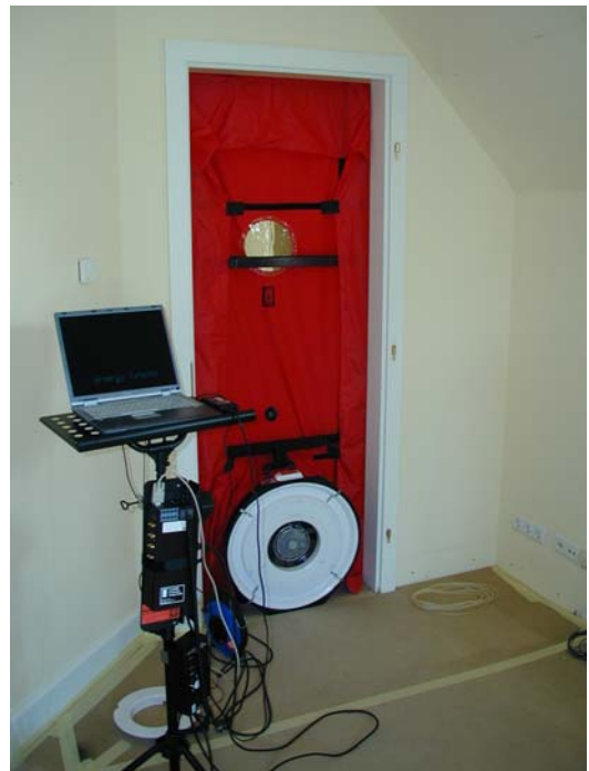
Abbildung 2.41: Messaufbau für eine Blower Door Test (arsenal research)
